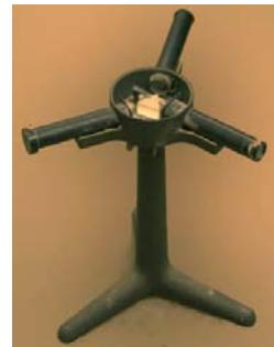
1. Найдите узкую щель на конце коллимирующей трубы. Направьте щель на изучаемый источник света. Смотрите в телескоп и двигайте прибор из стороны в сторону, держа за основание, пока наблюдаемый свет не станет наиболее ярким. Если света не видно, попробуйте подвигать телескоп при помощи расположенной под ним ручки. (Начинать лучше всего со среднего положения телескопа).
