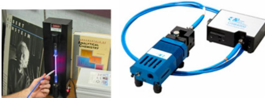
Рис. 15. USB4000 в качестве спектрофотометра
