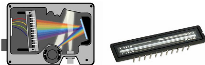
**Рис. 13. Спектрометр Ocean Optics с линейным ПЗС-детектором Toshiba**
