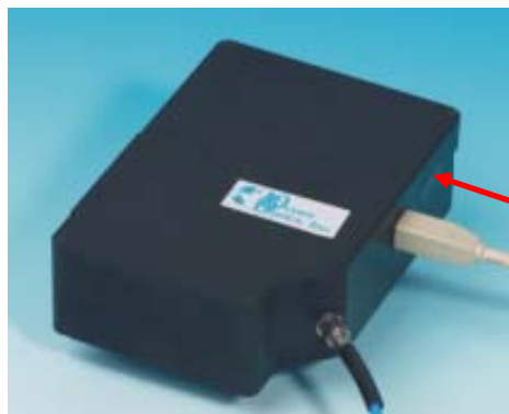
Расположение 30-контактного разъема на корпусе спектрометра HR4000
